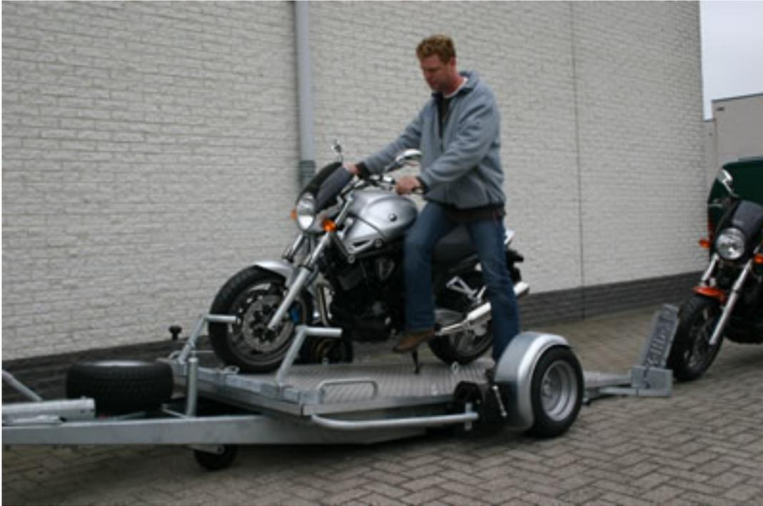
5. Spanngurte am Motorrad befestigen, zuerst auf der Seitenständerseite, das Motorrad mittels der Spanngurte aufrichten und Festzurren.
